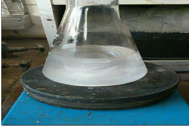
(صورة ١) توضيح ظهور اللون الأبيض للمعلق، مما يدل على تكون جسيمات الزنك النانوية ©تصوير الباحث
