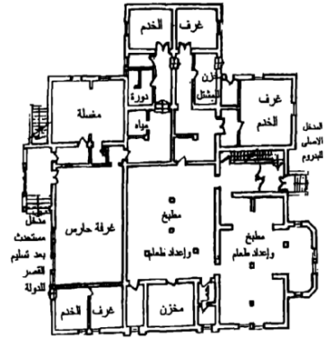
شكل (١) المَسقط الأفقي للبَدرُوم في قَصر عمرو إبراهيم قَبل تحويله لمتحف - مقياس رسم ١: ٥٠٠. المصدر، نجوى محمد، تحويل المباني التاريخية، ص ١٥٤
